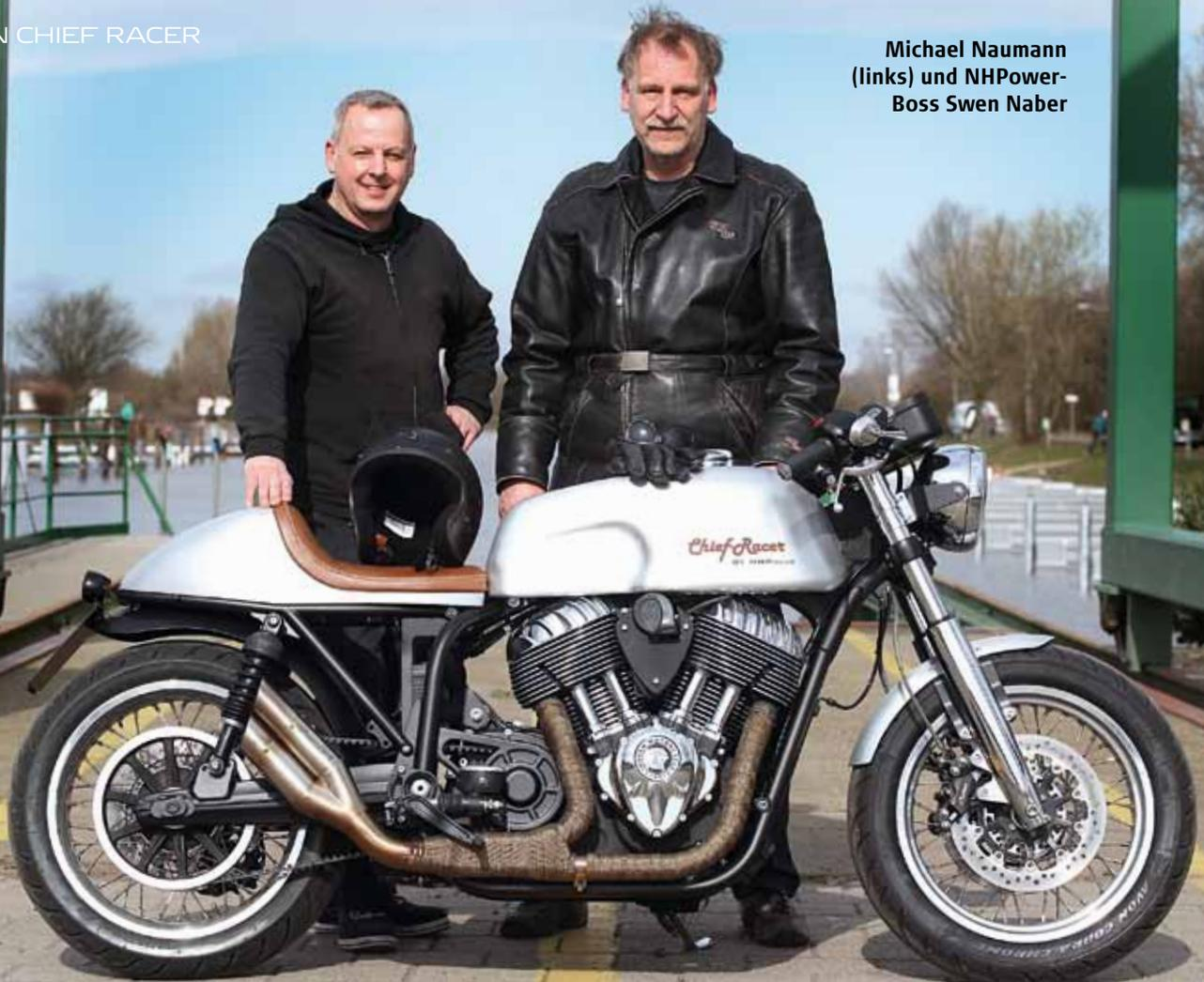
bis der Tank, der Höcker und der Frontfender passgenau angefertigt waren. Damit man sieht, dass diese Teile aus Stahlblech geformt sind, wurden sie nicht unter Kilos von Spachtel und Farbe versteckt, sondern roh geschliffen und montiert.
