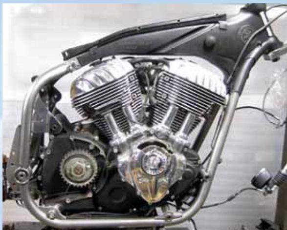
Vorher, nachher: Im Bild ganz links ist der originale Indian-Rahmen zu sehen, der größtenteils aus plattigen Aluminiumteilen besteht. Der Rahmen von NHPower besitzt neue Downtubes, Unterzüge und einen Schwingenaufnahmebereich aus Stahlrohr
