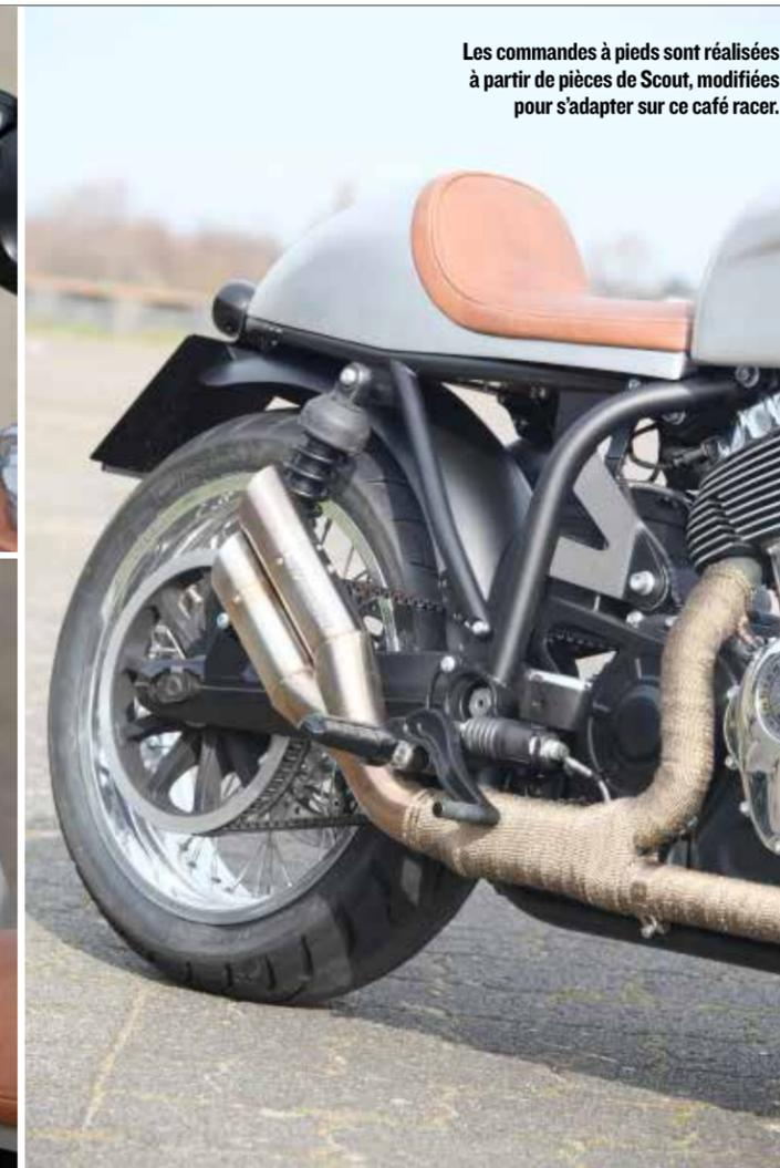
Les commandes à pieds sont réalisées à partir de pièces de Scout, modifiées pour s'adapter sur ce café racer.
