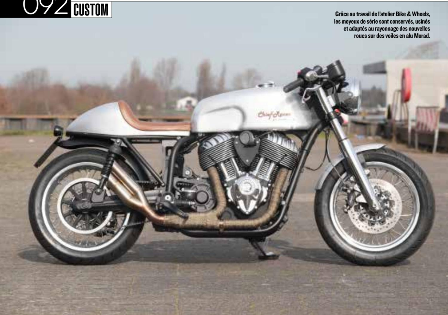
Grâce au travail de l'atelier Bike & Wheels, les moyeux de série sont conservés, usinés et adaptés au rayonnage des nouvelles roues sur des voiles en alu Morad.
